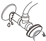
止水栓、給水配管は固く締め付けてください。- 締め付けないと水漏れの原因になります。
