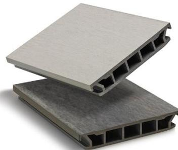
La surface de la lame Optima Eko est une peau en PVC coextrudée et poncée. Le PVC rend la lame totalement hermétique, et la finition poncée permet la bonne adhérence du plâtrage. En contrepartie, le ponçage peut provoquer une fine rétention d'eau localisée sur certains secteurs du plâtrage. Les avantages de la lame :
