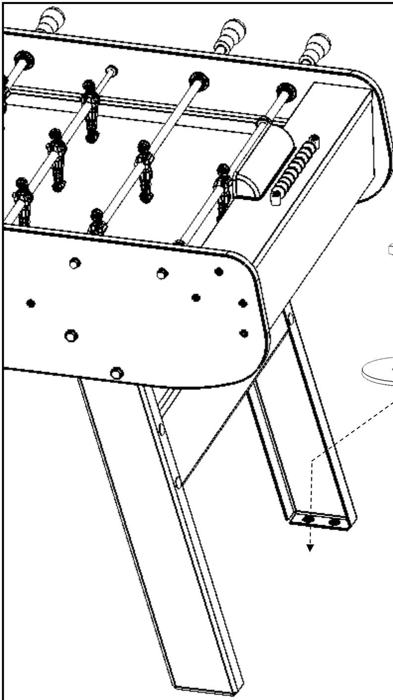
Pour fixer le baby-foot au sol, utiliser les perçages dédiés au tampon.
