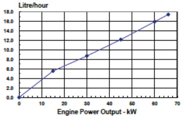
Las curvas mostradas anteriormente representan las capacidades de rendimiento de los motores en bruto, obtenidos y corregidos en acuerdo con GB/T18297 en condiciones de 100 kPa (29,61 in. Hg), presión barométrica [80 m (263 ft.) altitud], 25 °C (77 °F) entrada de la temperatura del aire y 1 kPa (0,30 in. Hg) presión de vapor de agua con No. 0 combustible diesel.
