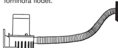
För längre hållbarhet, följ anvisningarna och *torrkör inte* pumpen. Stäng av strömbrytaren direkt efter användning.
