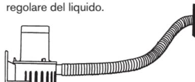
Per assicurare la più lunga durata possibile, seguire le istruzioni di montaggio ed **evitare di far girare a vuoto** la pompa. Chiudere l'interruttore direttamente dopo l'utilizzo.
