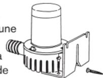
2. Brancher le câble brun à la borne positive (+) et à l'interrupteur. Brancher le câble noir à la borne négative (-). Nous recommandons un fusible de 2 A.
