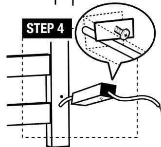
**ÉTAPE 4:** Passez le cordon électrique à travers le tube de montage de la connexion électrique (b) et utilisez la longue vis de montage (e) pour serrer le tube de montage de la connexion électrique sur la barre verticale.
