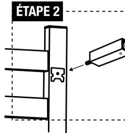
**ÉTAPE 2:** utilisez la vis courte (d) pour fixer le tube sur le petit carré métallique déjà attaché sur la barre verticale à l'arrière du chauffe-serviettes.
