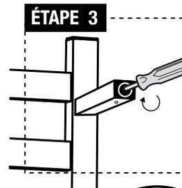
**ÉTAPE 3:** visser la vis courte (d) avec un tournevis. Notez que la vis de réglage du tube (a) doit pointer vers le sol lorsque le porte-serviettes est monté sur le mur. Fixez les trois tubes restant (a) sur les barres verticales en répétant l'étape 1-3.
