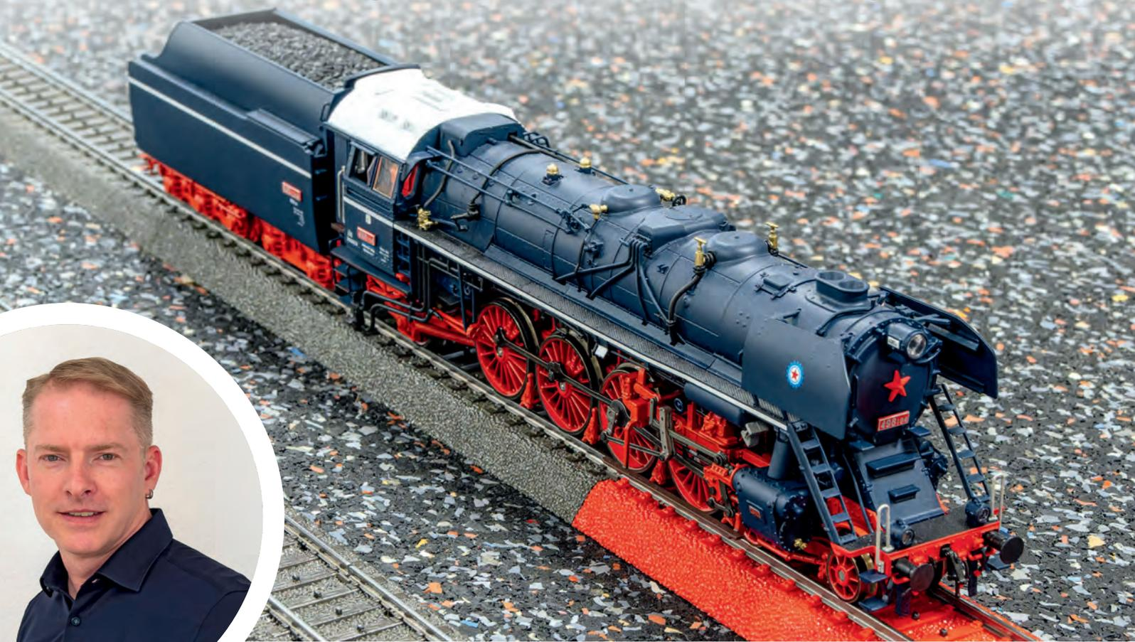
Die Schlepptender-Dampflok „Albatros“ im Testlabor: Das Modell der Museumslok 498.104 (Art. 39498) wird von der Qualitätssicherung in definierten Abläufen auf Zugkraft und Fahrverhalten geprüft. „Auch Sound und die Einstellwerte für Geschwindigkeit oder das Bremsverhalten zählen zum Aufgabenfeld“, berichtet Sven Dannenmann, Leiter der Abteilung Qualitätssicherung des Hauses Märklin.
