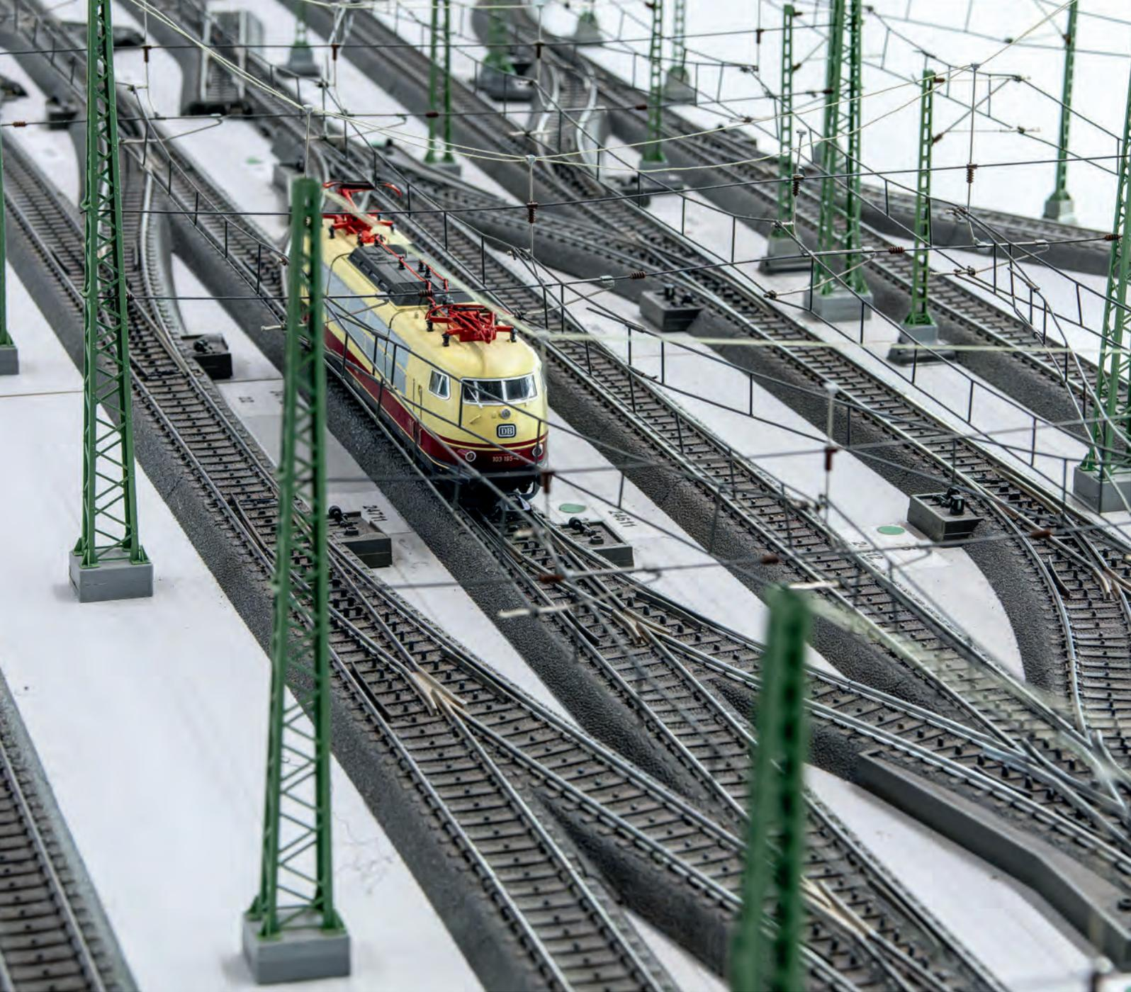
**Fahrprüfung:** Das Produktfreigabemuster der TEE-lackierten 103 195-4 (Art. 37573) meistert in allen Geschwindigkeiten anstandslos mit seinen sechs Achsen auch knifflige Weichenkonfigurationen, die wohl niemand auf seiner Anlage implementiert.
