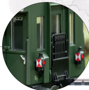
Achterste wagen met ingebouwd sluitlicht
