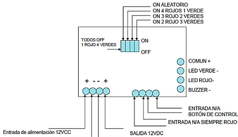
**Nota importante:** Para que el equipo obedezca la secuencia preseleccionada debe hacer el cambio con el equipo apagado.
