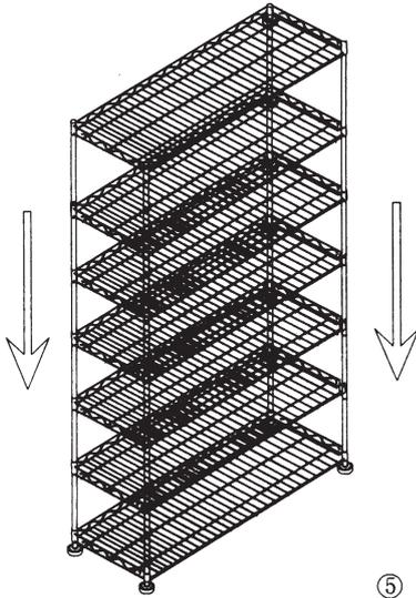
Fixer des manchons d'assemblage (B) autour de la rainure en haut des montants. Installer la tablette supérieure (D) au-dessus des 4 montants.
