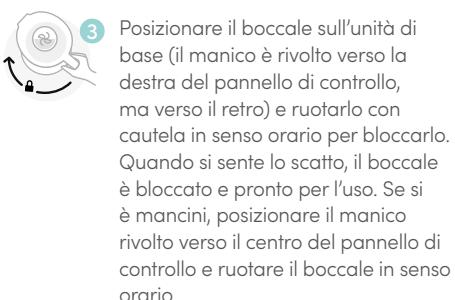
3 Posizionare il boccale sull'unità di base (il manico è rivolto verso la destra del pannello di controllo, ma verso il retro) e ruotarlo con cautela in senso orario per bloccarlo. Quando si sente lo scatto, il boccale è bloccato e pronto per l'uso. Se si è mancini, posizionare il manico rivolto verso il centro del pannello di controllo e ruotare il boccale in senso orario.
