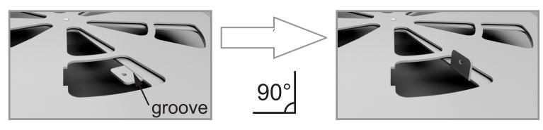
GENTLY HAND BEND THE DIFFUSER TAB ALONG THE GROOVE NO MORE THAN 90° ANGLE
