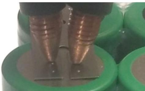
2. Dispara un pulso pisando el interruptor de pie - y manteniendo el pie abajo. No se asuste, los cables saltarán por la alta corriente que fluye a través de ellos, y el punto de soldadura puede emitir chispas. Verás que la iluminación de la pantalla LCD se atenúa brevemente - esto se hace a propósito para ahorrar energía durante el pulso.
