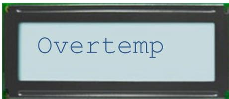
La temperatura del interruptor de encendido es superior a 70°C y debe enfriarse antes de continuar.
