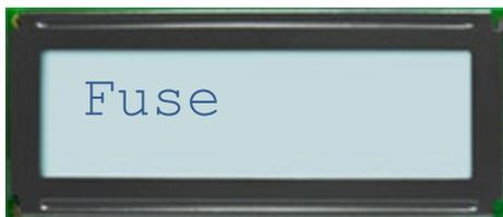
El sistema ha detectado un fusible roto. Intente siempre encontrar la causa raíz de la rotura antes de sustituirlo por uno nuevo.
