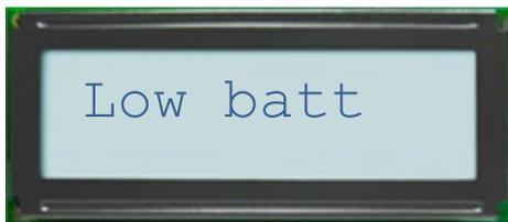
Ha habilitado un nivel de advertencia de voltaje de la batería, y el voltaje de la batería es inferior a eso.
