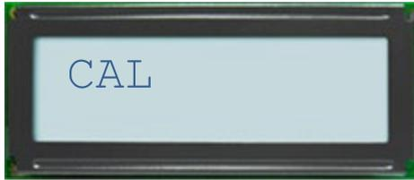
Se muestra cuando el sistema aún no ha sido calibrado. **NOTA:** debido a que el sistema se envía en este estado, esta es la primera pantalla que verá. Es necesario realizar una calibración una vez antes de poder utilizar la soldadora. Consulte la sección "Calibración" en la página 16 para obtener más detalles.
