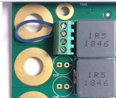
Para activar la fuente de alimentación, conecte un cable de puente (o un interruptor) como se muestra arriba.
