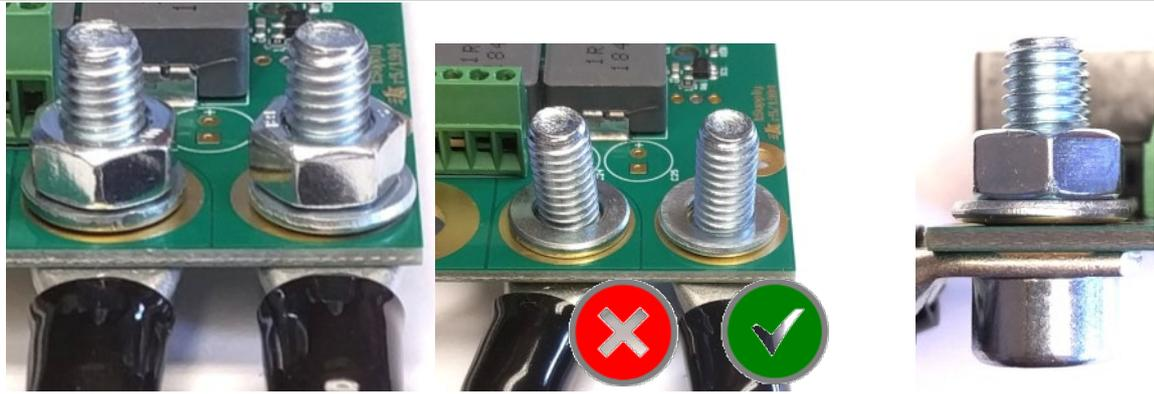
Utilice los tornillos M6, las arandelas y las tuercas para fijar los conjuntos de cables al módulo como se muestra. Apriete bien las tuercas. Observe la orientación correcta de las arandelas, de lo contrario podría dañar la placa de circuitos. Utilice el esquema de apilamiento que se muestra a la derecha.
