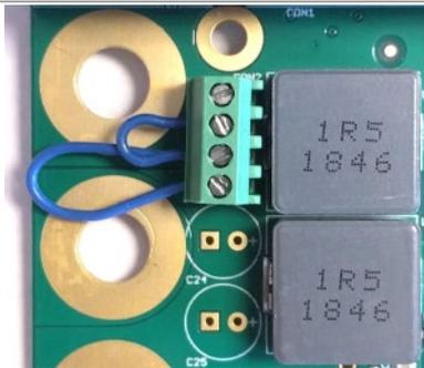
Para habilitar la fuente de alimentación, conecte dos cables de puente como se muestra arriba. Si desea añadir un interruptor, a continuación, insertarlo en el más largo de los dos bucles que se muestran.
