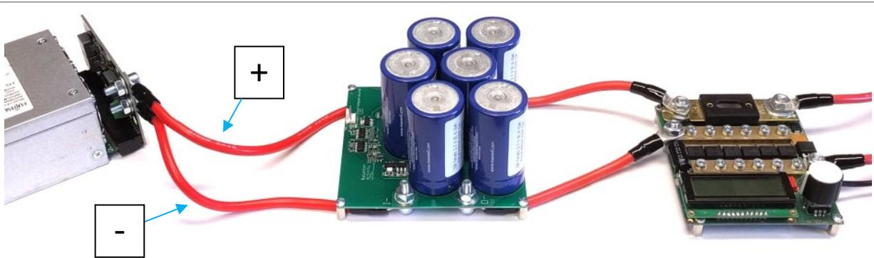
Conecte los cables a los terminales de entrada del módulo *kCap* como se muestra.
