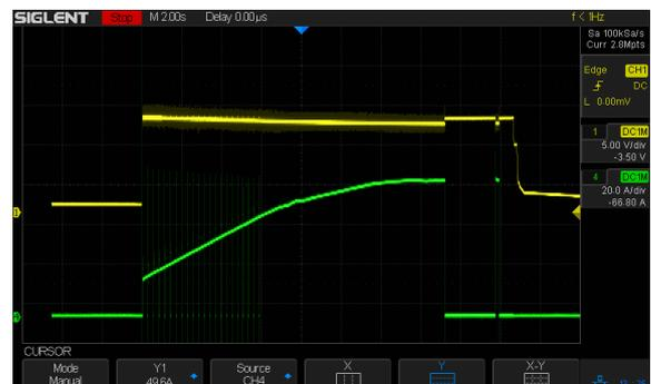
Cabe destacar que la longitud del cable de salida es menos crítica. Nuestras pruebas demostraron que los mismos cables de 55 cm aplicados a la salida no tenían efectos desestabilizadores similares.
