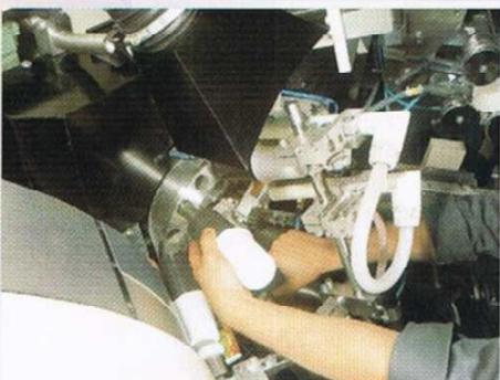
Schnellwechselformatteile garantieren kurzes Umrüsten. Automatisch nachstellbare Dornantriebe mit separat geregelter Synchroantrieb in der Druckstation.
