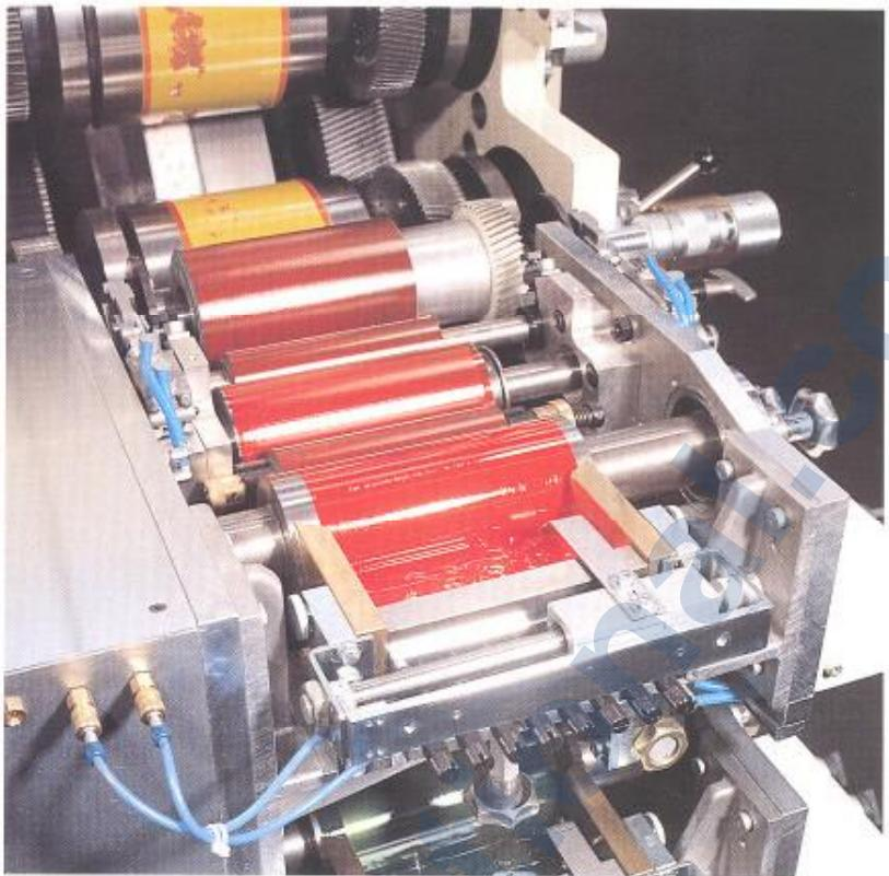
Farbwerke mit schnell demontierbarem- und leckfreiem Farbkastensystem sowie Farbverrührer
