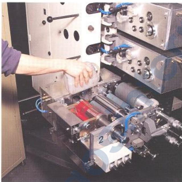
Separater Farbwerk'antrieb für automatisches Walzenreinigen und Einfärben, reduziert die Umrüstzeiten erheblich
