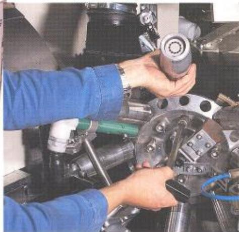
Schnellwechselformatteile garantieren kurzes Umrüsten
