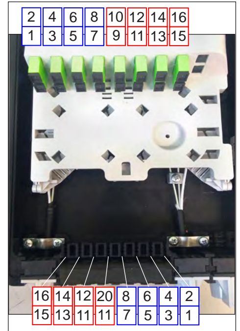
7.1. Para este proceso, utilice el diagrama de aplicación del Drop Óptico conectado de más arriba.
