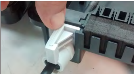
5.9. Acoplar el conjunto de sello del cable óptico en el compartimiento adecuado del cuerpo.
