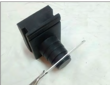
6.3. Cortar la goma de sello en el anillo transversal, de acuerdo con el diámetro del cable a ser aplicado.
