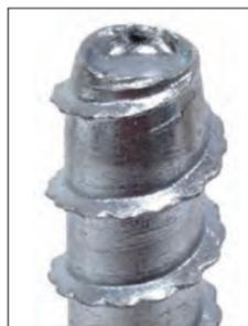
Los dientes aserrados de la punta del anclaje del tornillo Titen HD facilitan el corte y reducen la torsión de instalación.
