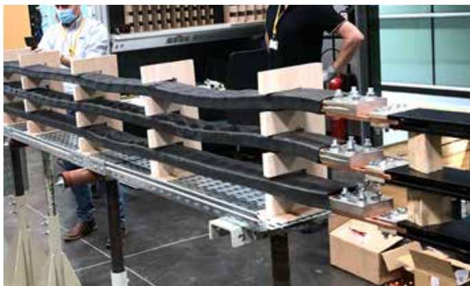
Imágenes de secuencias de ensayos de incremento de la temperatura y sonda/sensor de temperatura a lo largo de toda la instalación
