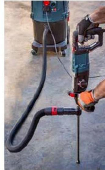
Broca de carburo hueca DXS de Bosch/Simpson Strong-Tie usada con el sistema de extracción de polvo por aspiración que se describe en la sección 3.2.3.2
