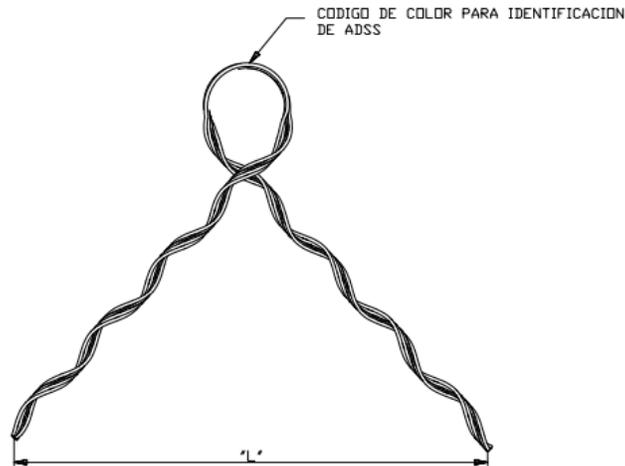
Para una correcta selección del conjunto de suspensión es necesario conocer el diámetro exterior del cable ADSS a instalar.
