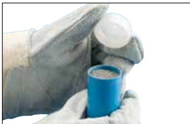
Fig. 19 Remove the lid over the mold crucible.
