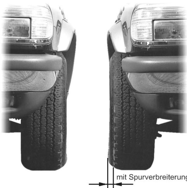
Passend für den Suzuki Vitara LY bieten wir Spurverbreiterungen in 15 mm, 18 mm, 24 mm und 30 mm pro Seite an, die optimal auf das Fahrzeug angepasst sind. Weitere Abmessungen auf Anfrage.
