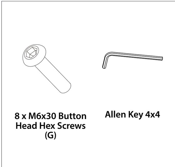
**4** Reliez les montants de gauche et de droite au niveau des pieds. Serrez les vis (G) à l'aide d'une clé hexagonale 4x4.
