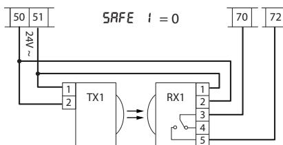
Fotocellule non verificate (Check ogni 6 mesi)
