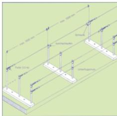
8-Reihiges Spanndrahtsystem mit Unterflugschutz auf Aluminiumflachstange zur Vergrämung der Vögel von möglichen Nist-/Landeflächen, wie Attiken, Lamellen, Gesimsen, Trägern, Dachvorsprüngen und weiteren, ebenen Bereichen.
