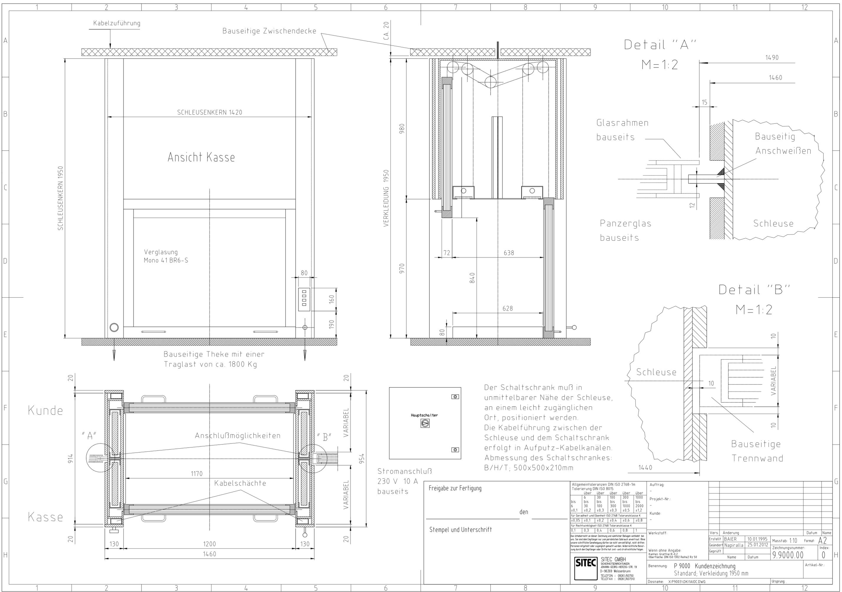
Der Schaltschrank muß in unmittelbarer Nähe der Schleuse, an einem leicht zugänglichen Ort, positioniert werden. Die Kabelführung zwischen der Schleuse und dem Schaltschrank erfolgt in Aufputz-Kabelkanälen. Abmessung des Schaltschranks: B/H/T; 500x500x210mm
