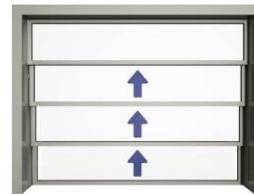
Fenster mit drei Schiebeabschnitten
