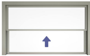
Fenster mit einem Schiebeabschnitt
