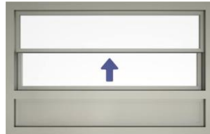
Festes Aluminiumprofil unterhalb des Fensters
