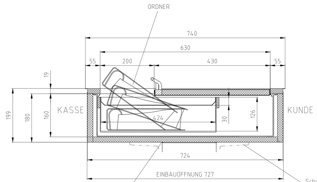
Schiebemulde bauseits durch Konsolen unterstützen
