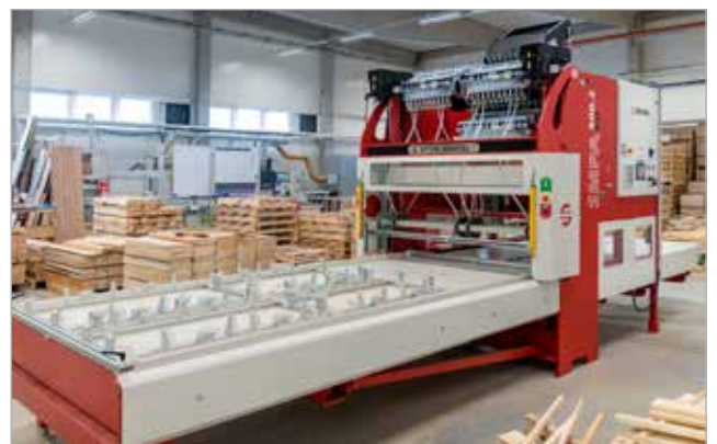
Stapelmaschine zur Herstellung von Paletten
