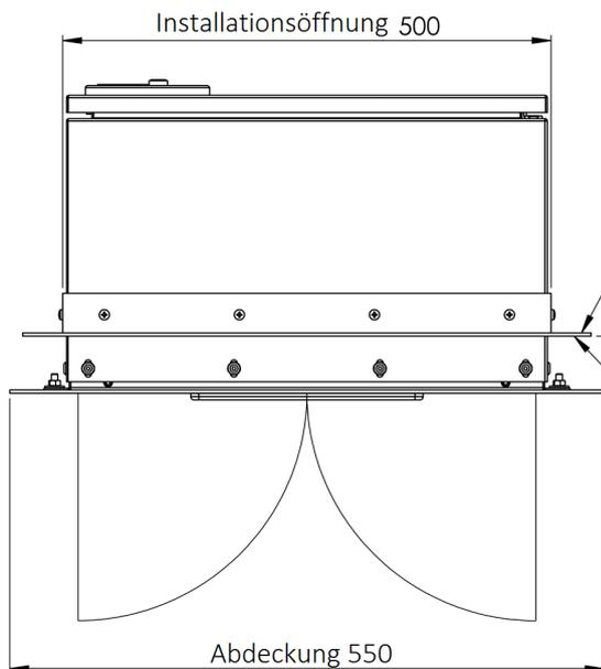
Montagerahmen gewinkelt 40x40x3 wird individuell angepasst und mit der Wand fixiert während der Montage - Oberfläche RAL... pulverbeschichtet
