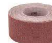
Abranet® SIC NS : est un abrasif polyvalent à maillage ultrafin, sans stéarate, principalement conçu pour le ponçage du verre mais convenant également au ponçage d'autres surfaces dures comme les primers, les vernis et les composites. Associe hautes performances et une plus longue durée de vie que les abrasifs traditionnels, ce qui le rend particulièrement rentable. Son encollage à base de résine forme une couche régulière de grains de carbure de silicium au poudrage fermé.
