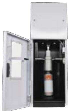
**CUSTOM CAN™ Centre de Couleurs****Machine de Remplissage Pneumatique Custom Can**
