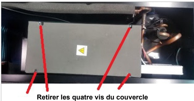
Figure 17. Retrait des vis du boîtier électrique
