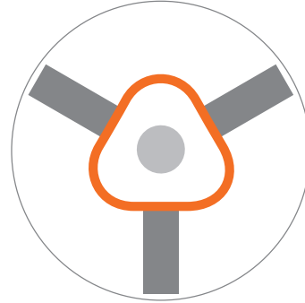
従来の3点クランプ Conventional 3-point clamping
