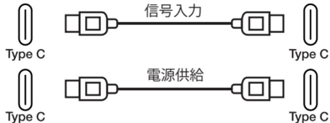
この接続方法を利用するには、携帯電話のUSB-Cポートが映像出力と電源供給に対応している必要があります。対応していない場合、モニターの電源アダプターを利用いただく必要があります。
