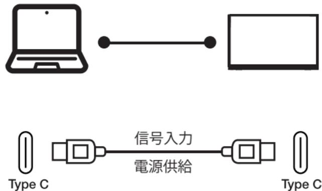
この接続方法を利用するには、ノートPCのUSB-Cポートが映像出力と電源供給に対応している必要があります。対応していない場合、HDMI及びモニターの電源アダプターを利用いただく必要があります。
