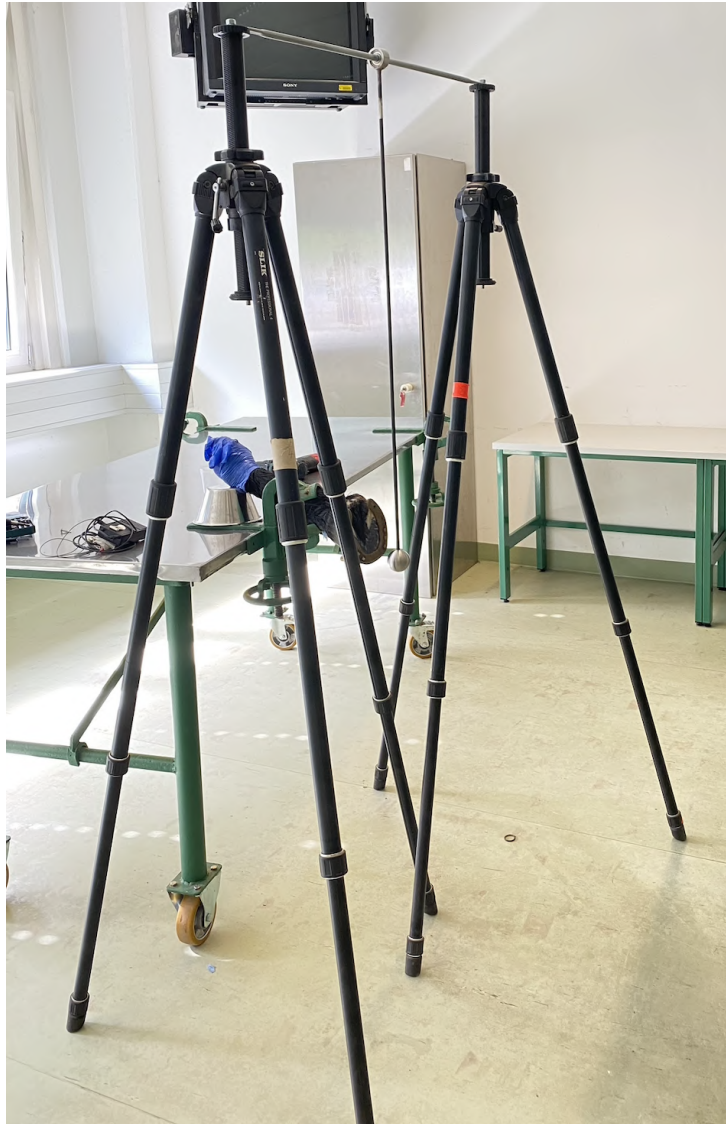
Abbildung 13: Positioniertes Pendel auf den Fotostativen
