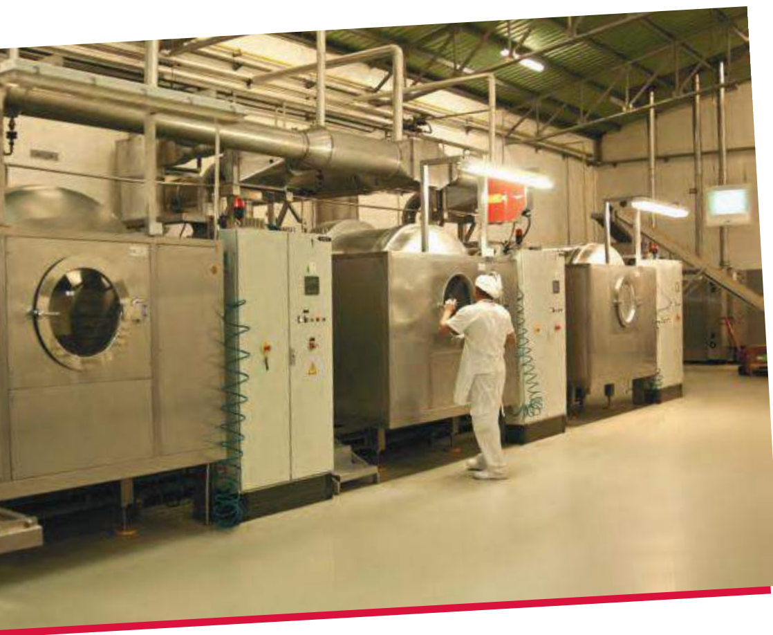
Fotografia das drageadoras automáticas da Secção de Confeitaria. Data: 2017. Autoria: Rita Duro. Arquivo Vieira de Castro – Produtos Alimentares S.A.
