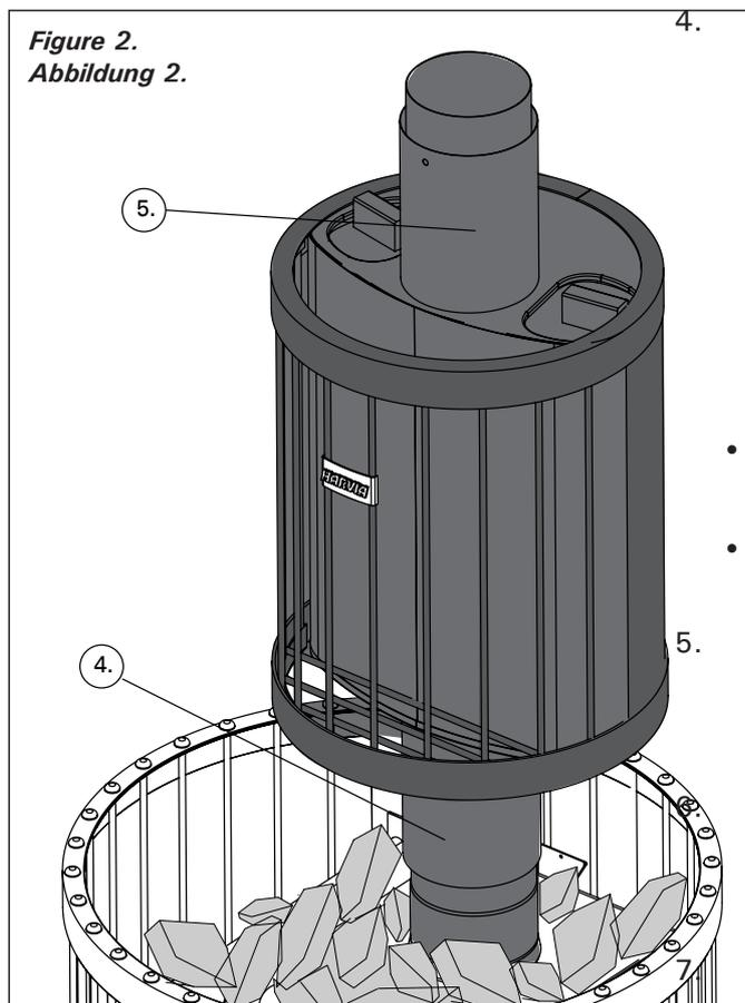
Setzen Sie den schwarzen Hitzeschutz H = 15 (Teil 5) über dem Warmwasserbehälter und um das Anschlussrohr ein. Wenn Sie einen Schutzmantel oder einen anderen Schutz verwenden, der umgebende brennbare Materialien nicht vor der Wärmestrahlung des Warmwasserbehälters und Anschlussrohrs schützt, verwenden Sie den mitgelieferten Hitzeschutz.
