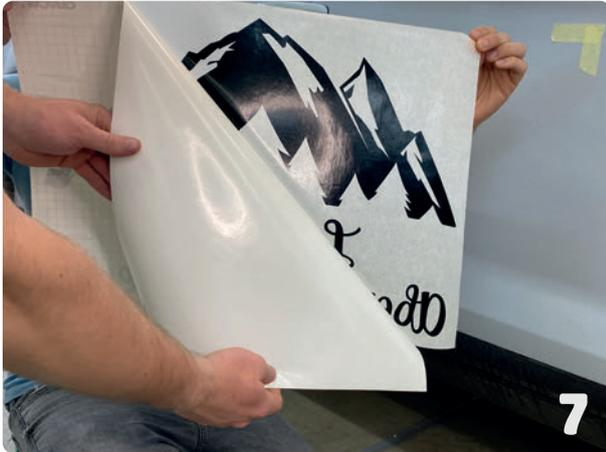
Trägerpapier vorsichtig komplett von Transfertape ablösen. Klebefolie auf Klebeseite vollflächig mit Seifenwasser besprühen. (geht am besten zu zweit)
