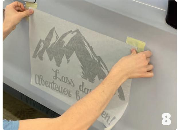
Die Klebefolie mit Hilfe der Markierung an gewünschte Stelle auf Fahrzeug positionieren.
