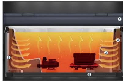
**5-stufiges „Platinum-Lock“ Vollschaum Isoliersystem** - basierend auf jahrzehntlang bewährter Kühlschrankschrank-Isolier-Technologie:
