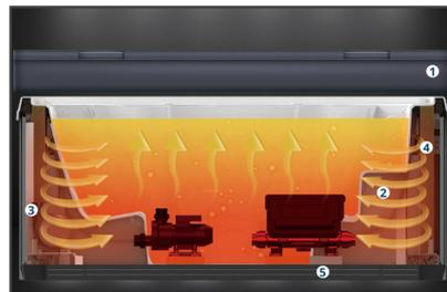
**5-stufiges „Platinum-Lock“ Vollschaum Isoliersystem** - basierend auf jahrzehntelang bewährter Kühlschrankschrank-Isolier-Technologie:
