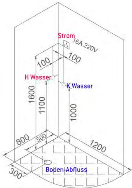
Zeichnung der bau-seitigen Voraussetzungen für die Linksversion. (Rechtsversion ist seitenverkehrt)
