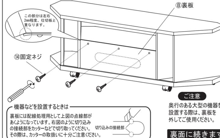
機器などを設置するときは裏板には配線処理用として上図の点線部があくようになっています。右図のように切り込みの接続部をカッターなどで切り取ってください。切り込みの接続部その際は、カッターの取扱いに十分ご注意ください。
