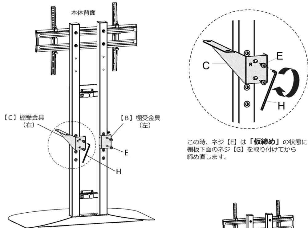
この時、ネジ【E】は「仮締め」の状態に。棚板下面のネジ【G】を取り付けてから締め直します。
