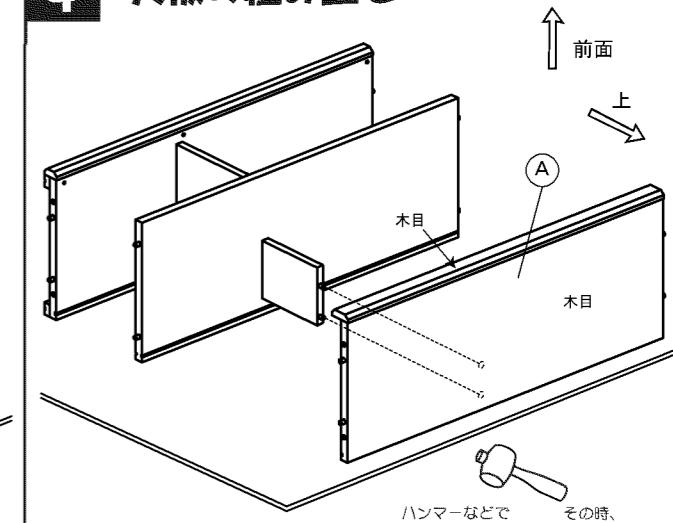
5 金属ダボの側板への取り付け
