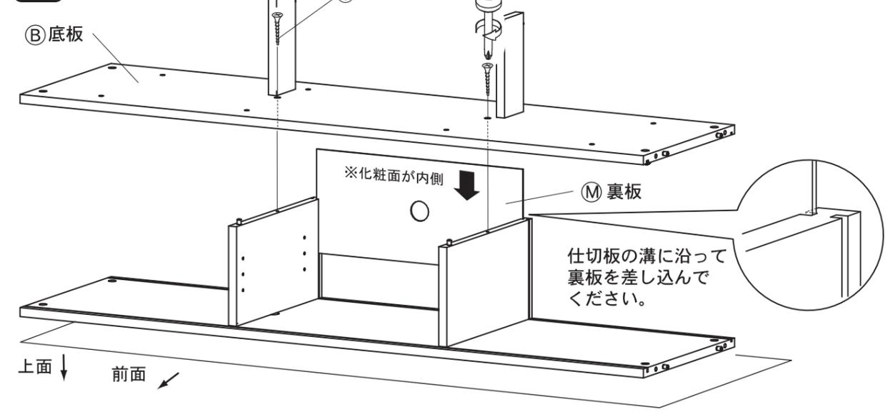
4 締付けネジの取り付け、カムネジの取り付け、裏板の取り付け
