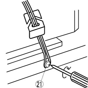
ロープがV字状に取付けが出来たらプレートを図の向きにし、上に引き上げてロープを張らせます。ロープが張った状態でプレートのミゾにロープを引っ掛けで固定します。
