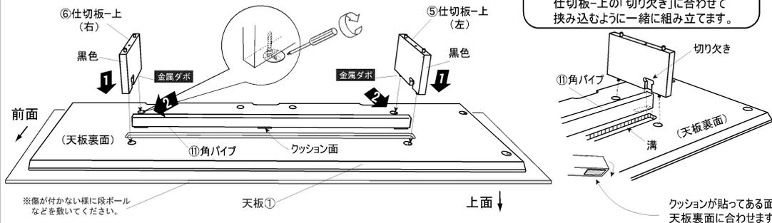
角パイプを天板裏面の溝に入れ、仕切板-上の「切り欠き」に合わせて挟み込むように一緒に組み立てます。
