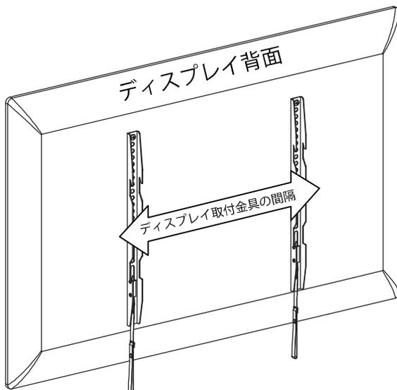
予めストッパーを「受け金具」へ設置する位置を確認してからディスプレイ取付金具の間隔より少し広めに取り付けてください。
